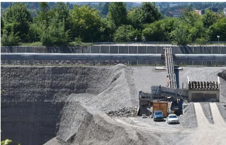
Im Kieswerk wird das Material aufbereitet, in verschiedene Korngrößen unterteilt und verkauft oder zu Beton weiterverarbeitet. Das Förderband ist zurzeit knapp 1 km (1'000 m) lang und wird mit fortschreitendem Abbau stetig verlängert. Dank diesem Förderband kann der Kies umweltfreundlich zum Kieswerk transportiert werden.
