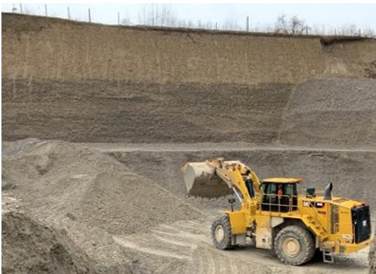
Unter der Moräne folgt die verwertbare Schotterschicht. Der Schotter besteht hauptsächlich aus Kies und Sand (Korngrößen von 0.063 – 63 mm) sowie einzelnen grösseren Steinen und einem geringen Anteil an Feinkorn (<0.063 mm). Das Material wird mit einem PneuLader in 6 m mächtigen Schichten abtragen und über ein Förderband bis ins Kieswerk transportiert (Foto Risi AG, 10.04.2020).
